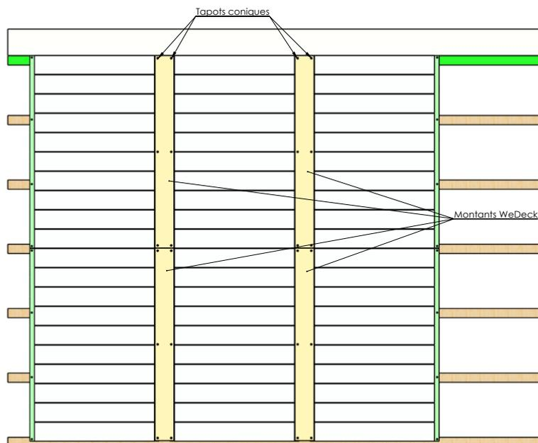
1. Disposer le montant en insérant des cales fourchettes de 4 mm de part et d'autres
